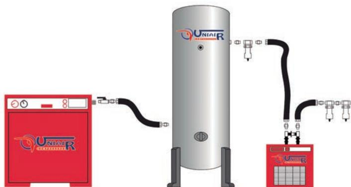
El esquema adjunto indica las conexiones entre depósitos, secadores y filtros.
